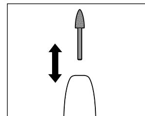
2. Nasazený nástavec z přístroje stáhněte a nový nástavec vložte do otvoru na nástavci.
