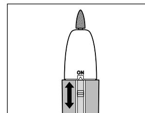
▷ **Zapnutí:** Posuňte vypínač směrem nahoru až na doraz.
