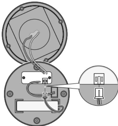
Pouzdro s elektronikou a solární modul nahoře ve víku jsou propojeny kably.
