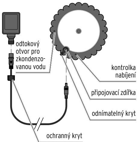
2. Zasuňte jeden konec připojovacího kabelu do připojovací zdířky na spodní straně stínítka lampy a druhý konec do připojovací zdířky na síťovém adaptéru. Ochranný kryt pevně utáhněte.
