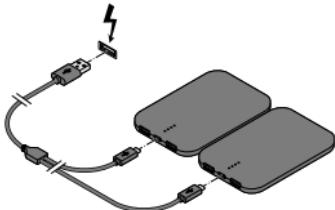
Zapojte malé konektory přiloženého nabíjecího kabelu do vstupních zdírek na akumulátorech.
