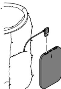
Připojovací kabel vyhřívané papuče zapojte do některé z výstupních zdírek akumulátoru.
